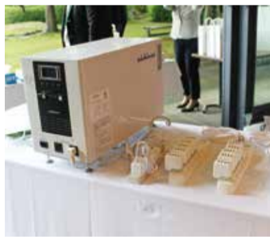
▲スマートフォン100台分を充電できるポータブル蓄電池も設置。
