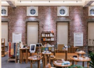
↑「Oita Made」の店内。内壁には建設当初の赤レンガを使用し、再建時のコンクリートの柱、化粧梁を修復再現した
